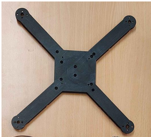
Bild 3. Bilden visar drönarens 3D-skrivna ram med färdiga hål för enkel montering.
